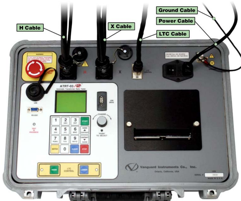
Figura 4. Conexiones típicas del Panel de Control
